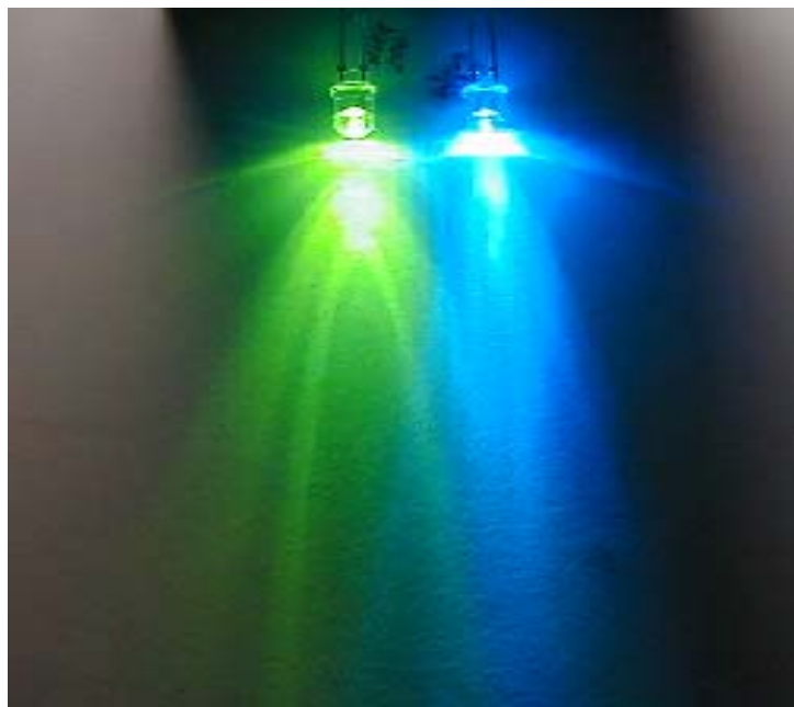
超高輝度発光ダイオード (Green:525nm & Blue: 470nm LED)
